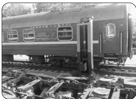
Obr. 3 – Výměna podvozku vlaku – stanice Čop.
